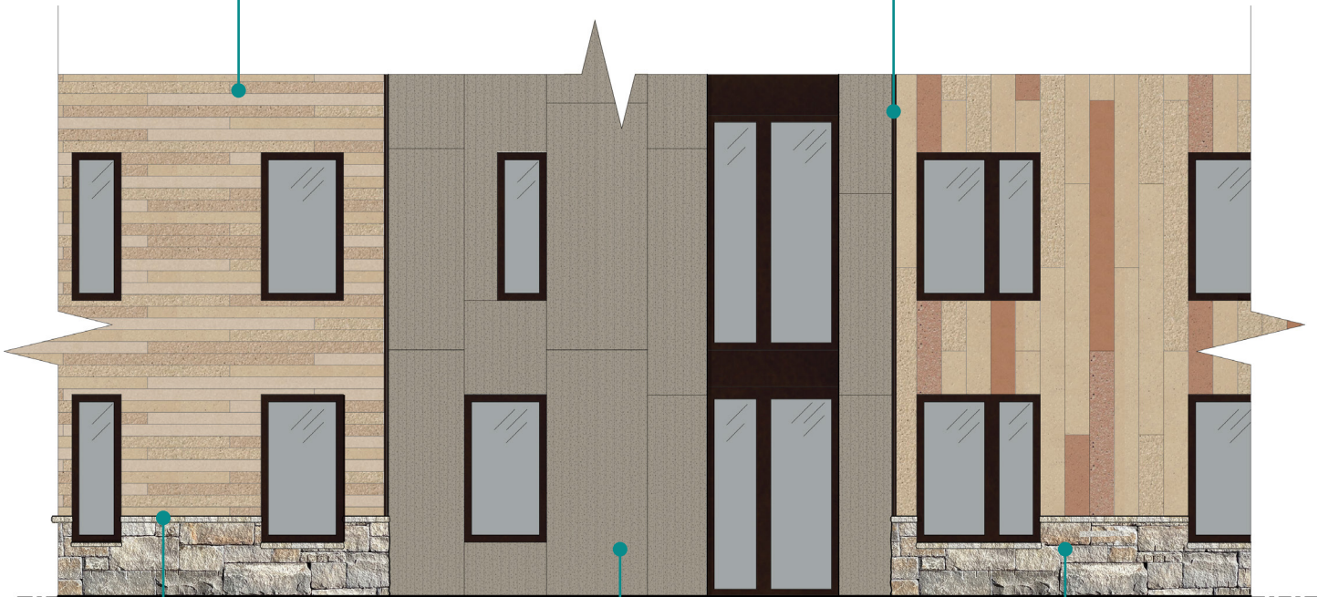
EW1.3 - GFRF PANEL ON MTL STUD
