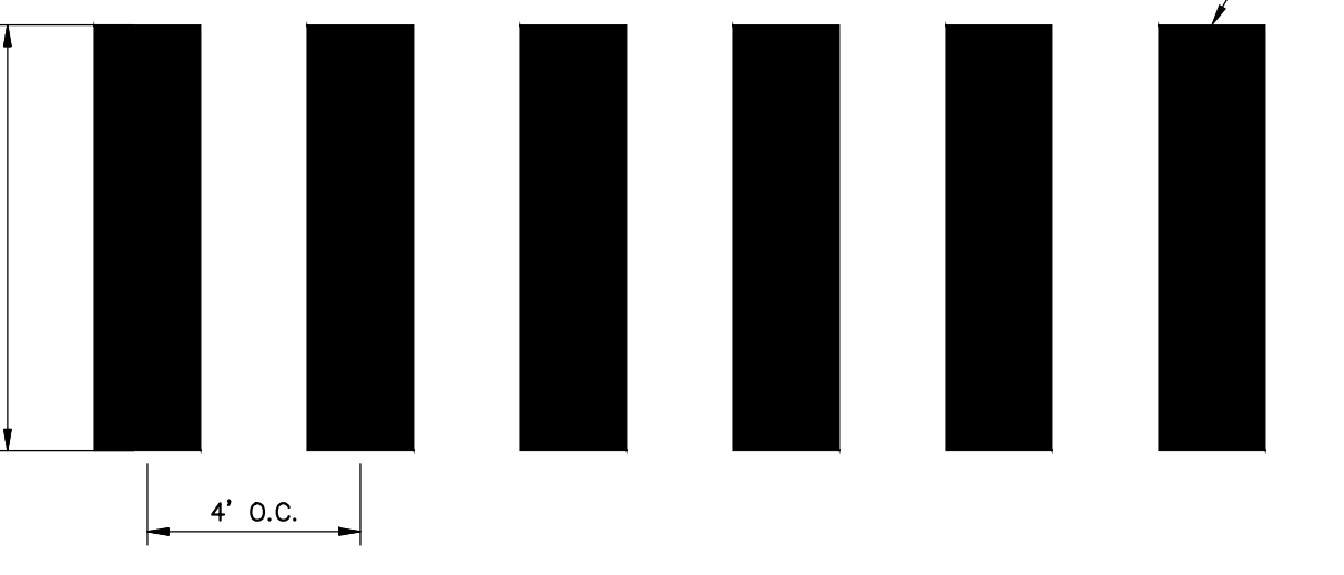
CROSSWALK WITH LONGITUDINAL LINES N.T.S.
